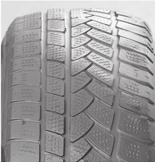
Auch die Reifen leiden unter defekten Stoßdämpfern, da durch den instabilen Fahrbahnkontakt Auswaschungen an der Lauffläche entstehen, so dass nicht nur Stoßdämpfer, sondern auch Reifen getauscht werden müssen.
