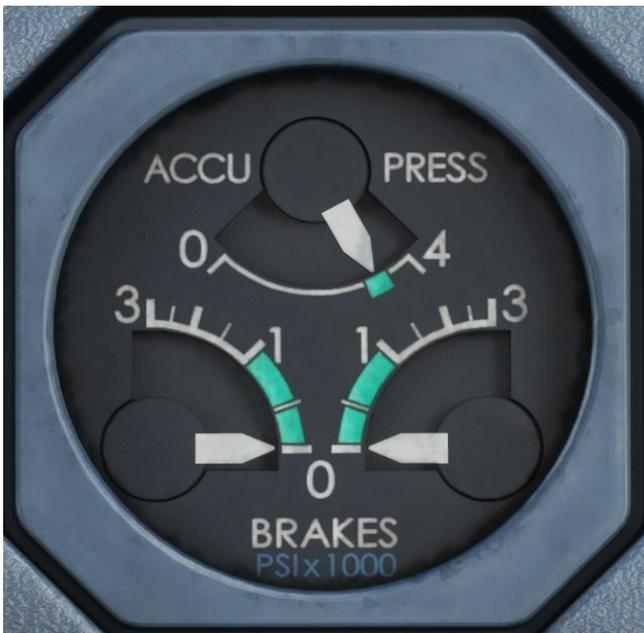
ACCU PRESS = Akkumulatordruck YELLOW HYD (max. 7 Betätigungen)
