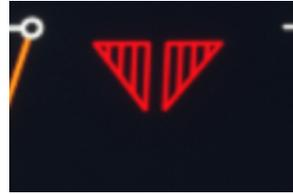
Fahrwerk ausgefahren und verriegelt
