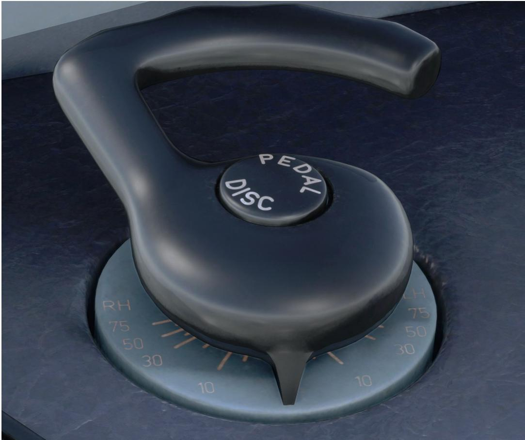
Unterbindet die Nose Wheel Steuerung durch die Ruderpedale.
